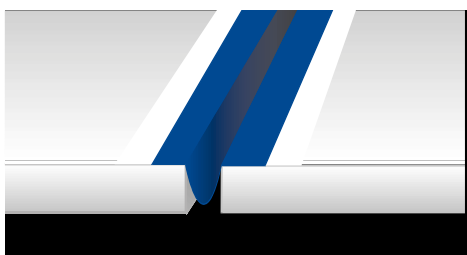
Ω-placering av Mapeband inuti en expansionsfog
